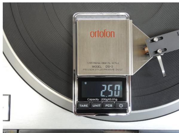
7. Die Waage einschalten und den Tonabnehmer auflegen (Bild), dazu den Tonarm mit dem Lift absenken, siehe Abbildung 2.9 auf Seite 14.
